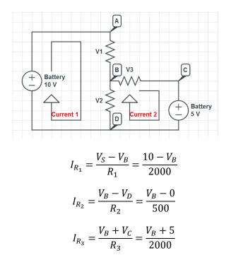
$$I_{R_1} - I_{R_2} - I_{R_3} = 0$$
